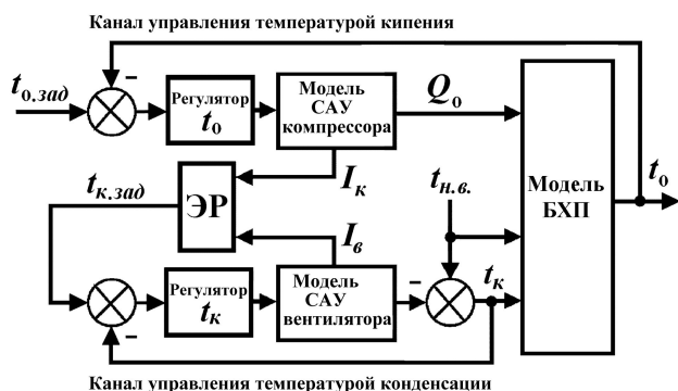
Рис. 2. Упрощенная структурная схема двуканальной САУ БХП
