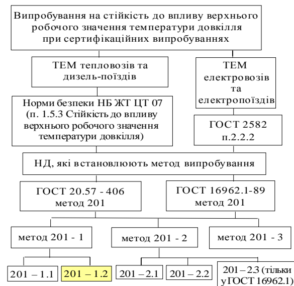
Рис.1. Схема випробувань ТЕМ за методом 201
