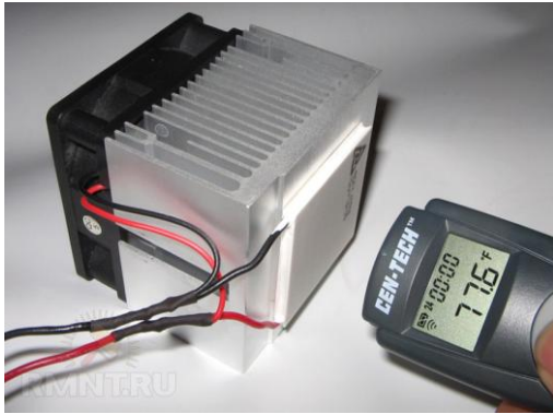
Рис. 10. Зображення модуля охолодження з використанням елемента Пельтьє, радіатора та кулера
