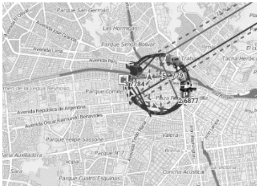
Рис. 4 Деградація точності позиціонування, що призводить до розходження між реальною траєкторією та даними GPS.
