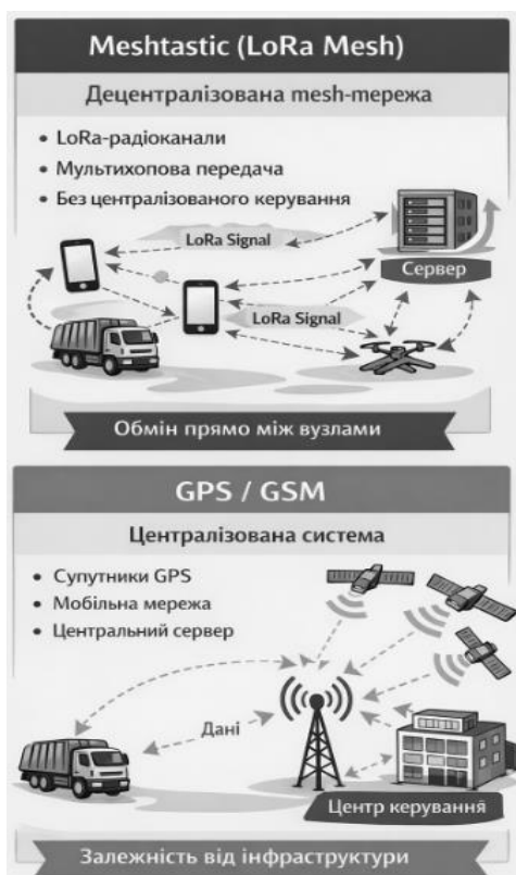
Рис. 1. Структурна схема відмінностей передачі телеметричних даних у системі оперативного керування мобільними платформами з використанням Meshtastic (LoRamesh) та стандартного каналу GPS.
