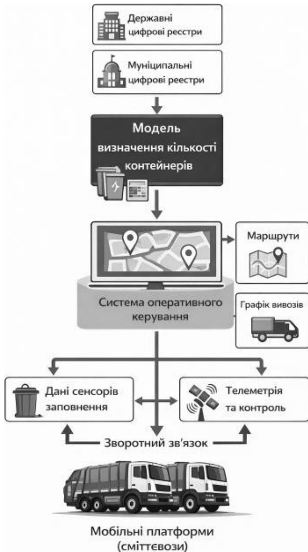
Рис. 2 - Структурна схема інтеграції демографічних даних у систему оперативного керування та віддаленого контролю мобільних платформ.
