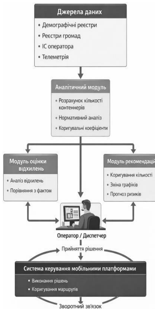
Рис. 1 - Функціональна схема системи підтримки прийняття рішень (DSS)
