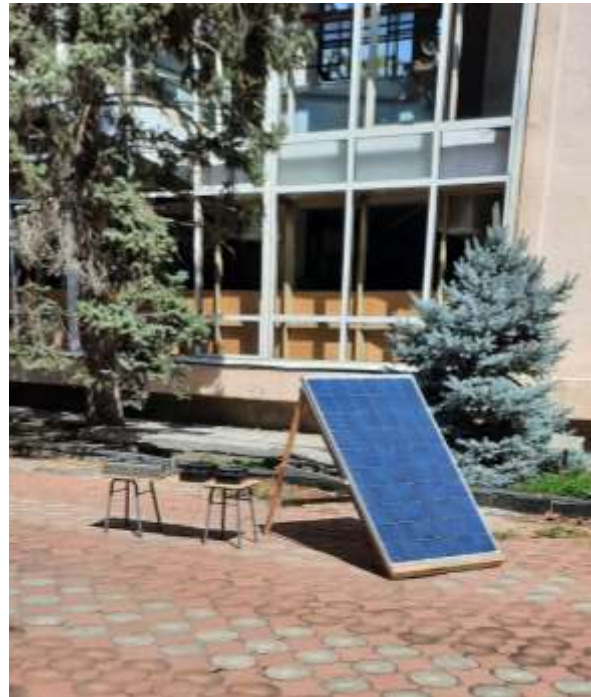
Рис.2. - Стенд досліджень вольт-амперних характеристик фотоелектричних панелей
