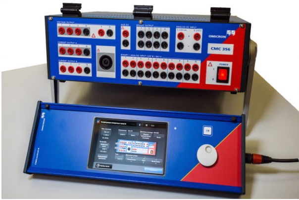
Рис. 4. Апаратно-програмний випробувальний комплекс на базі пристрою CMC 356 фірми OMICRON.
