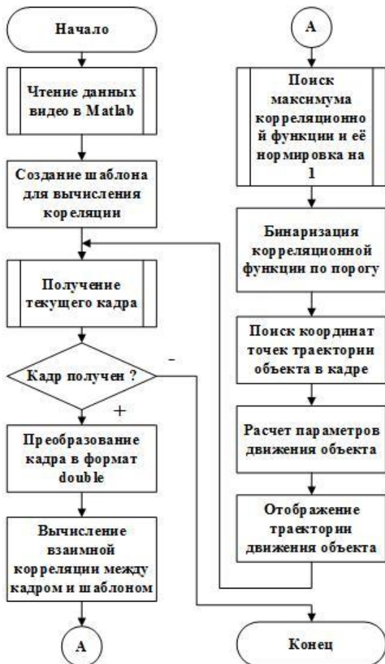
Рис. 1. Структура корреляционно-экстремального алгоритма
