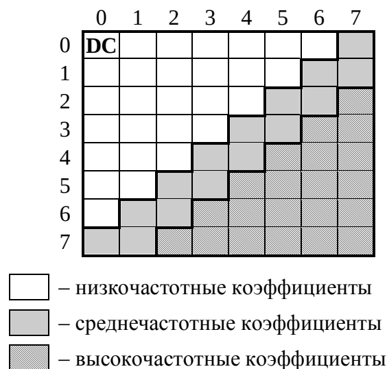
Рис. 1. Стандартное разбиение блока изображения в пространстве ДКП
