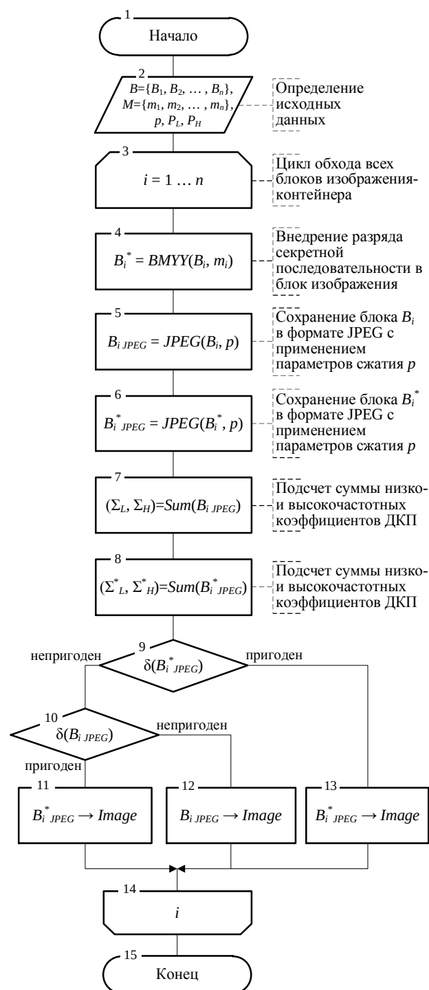
Рис. 2. Блок-схема предлагаемой апостериорной процедуры классификации блоков при встраивании
