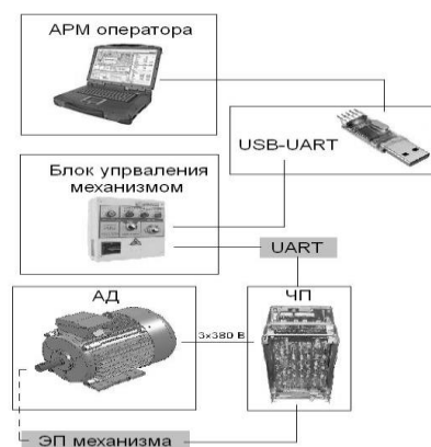
Рис.1 – Трехуровневая система контроля и управления
