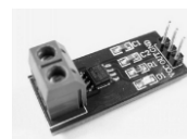
Рис.11 – Общий вид датчика тока 20A ACS712 на эффекте Холла
