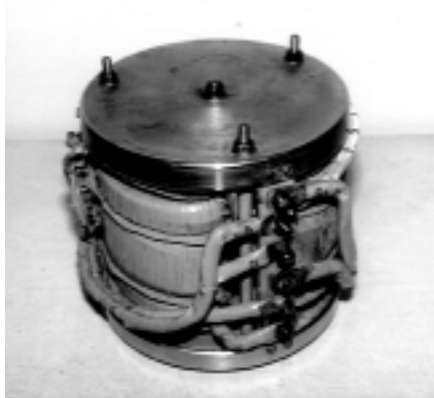
Рис. 4. Трёхфазный трансформатор с пространственным стыковым магнитопроводом мощностью 6,3 кВ·А
