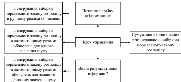
Рис. 1. Функціональна блок-схема генератора вибірок нормального закону розподілу.
