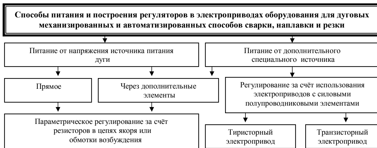
Рис. 2. Способы питания и построения регуляторов в электроприводах оборудования для механизированной и автоматической сварки
