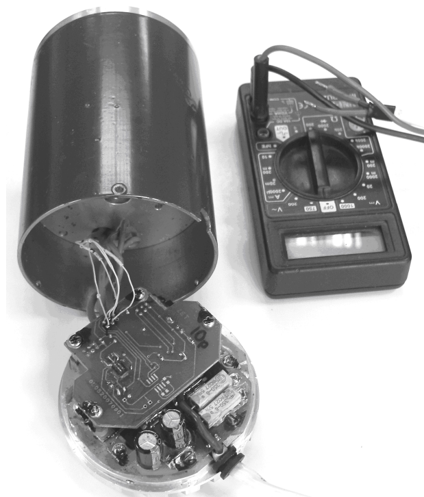
Рис. 4. Вентильный электродвигатель с интегрированной системой определения частоты вращения вала
