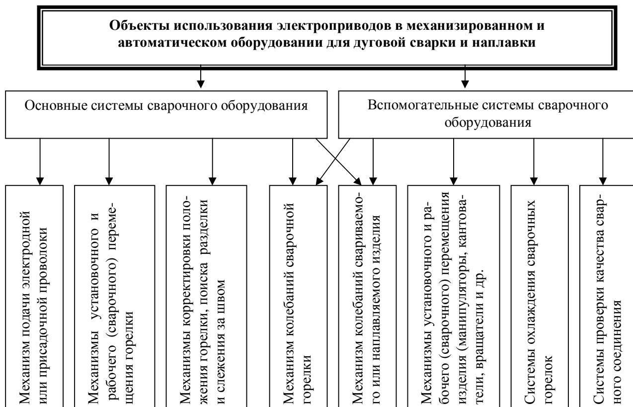
Рис. 3. Механизмы и системы основного и вспомогательного сварочного оборудования, комплектуемые электроприводами
