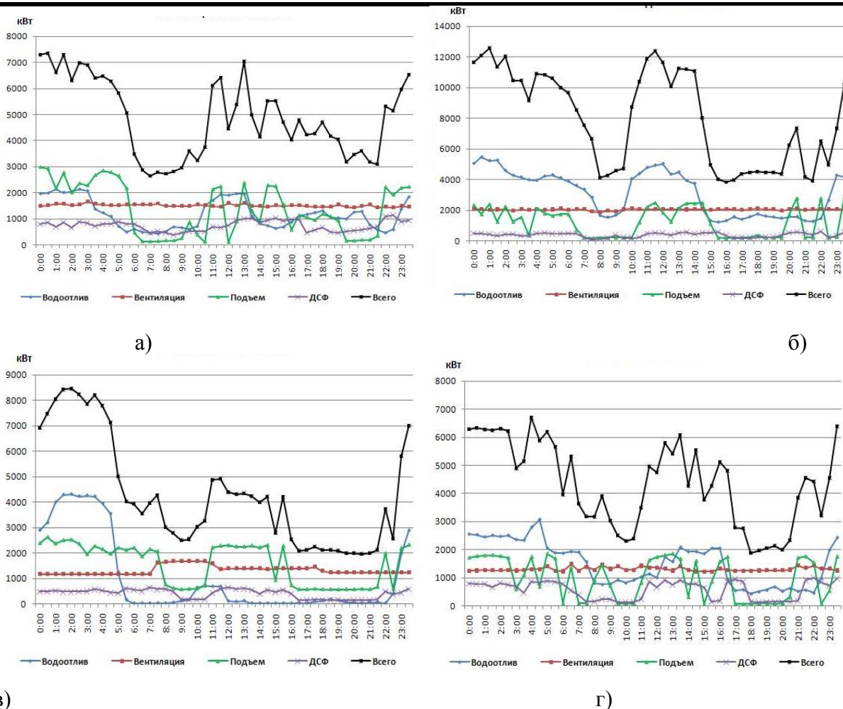
Рисунок 1 – Суточные графики электрических нагрузок технологических установок: а - ш. Октябрьская, б - ш. Родина, в - ш. Гвардейская, г - ш. им. Ленина ПАО «Криворожский железорудный комбинат»
