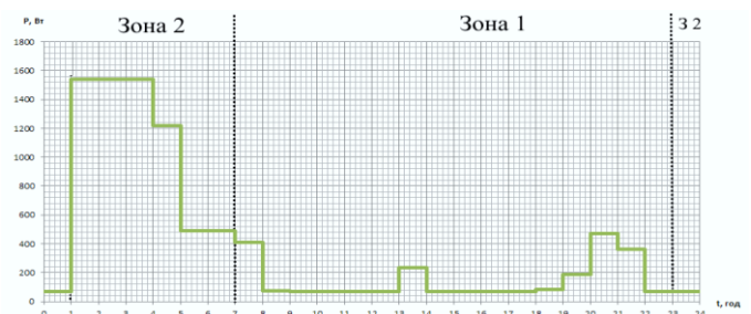
Рис. 6. Добовий ступінчатий графік навантаження квартири за умови перенесення частини навантаження на нічні години при двозонному тарифі
