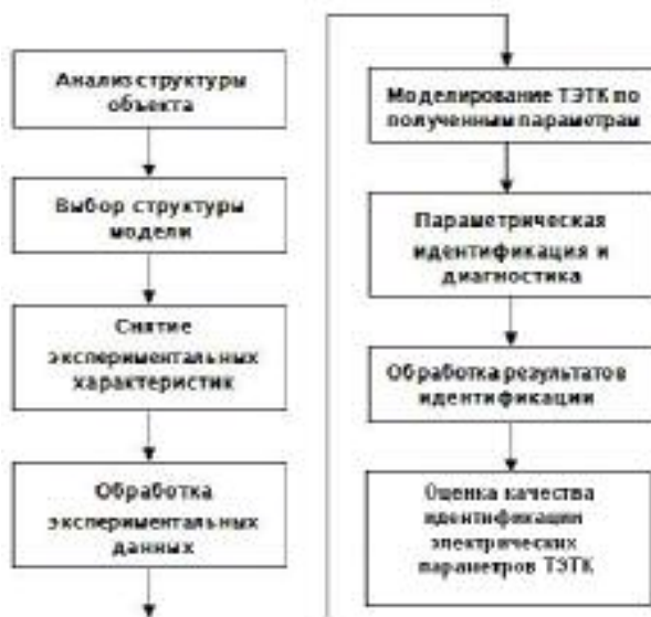
Рис. 1. Последовательность операций при идентификации и диагностике параметров тяговых асинхронных электрических двигателей шахтных электровозов
