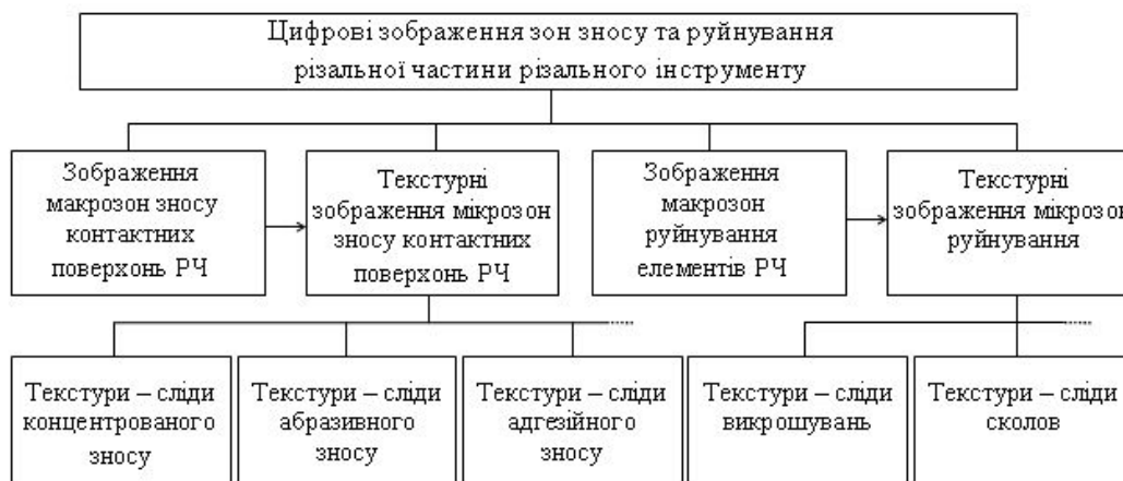
Рис. 4. Загальна класифікація текстурних зображень зон зношування та пошкодження різальної частини різального інструменту.
