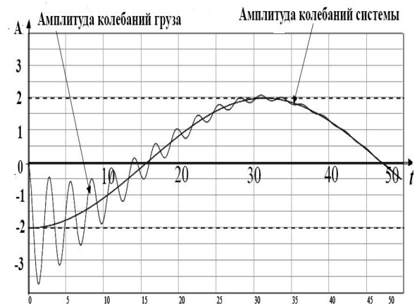
Рис. 2. График колебаний груза при \Omega \ll \omega_0 ( \Omega = 0,1 рад/с, A_{max} = 3,7 см)
