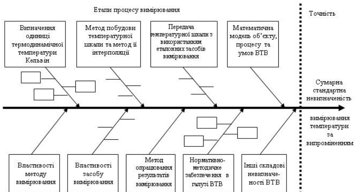
Рис. 1 Причинно-наслідкова діаграма впливу окремих етапів вимірювання на точність вимірювання температури за випромінюванням
